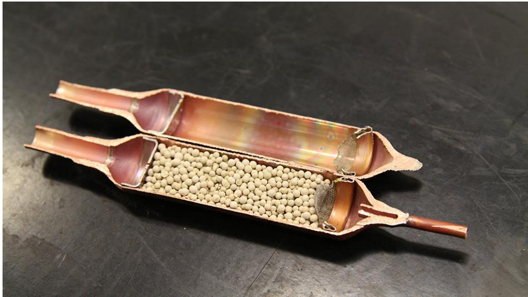
Figura 10 - Parte interna do filtro secador
