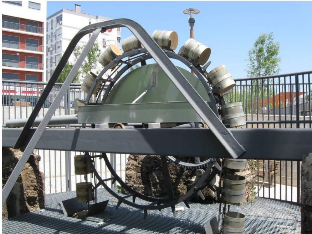
Fig. 3: Exemplo de uma Nora – roda d'água usada para transferência de cisternas.
