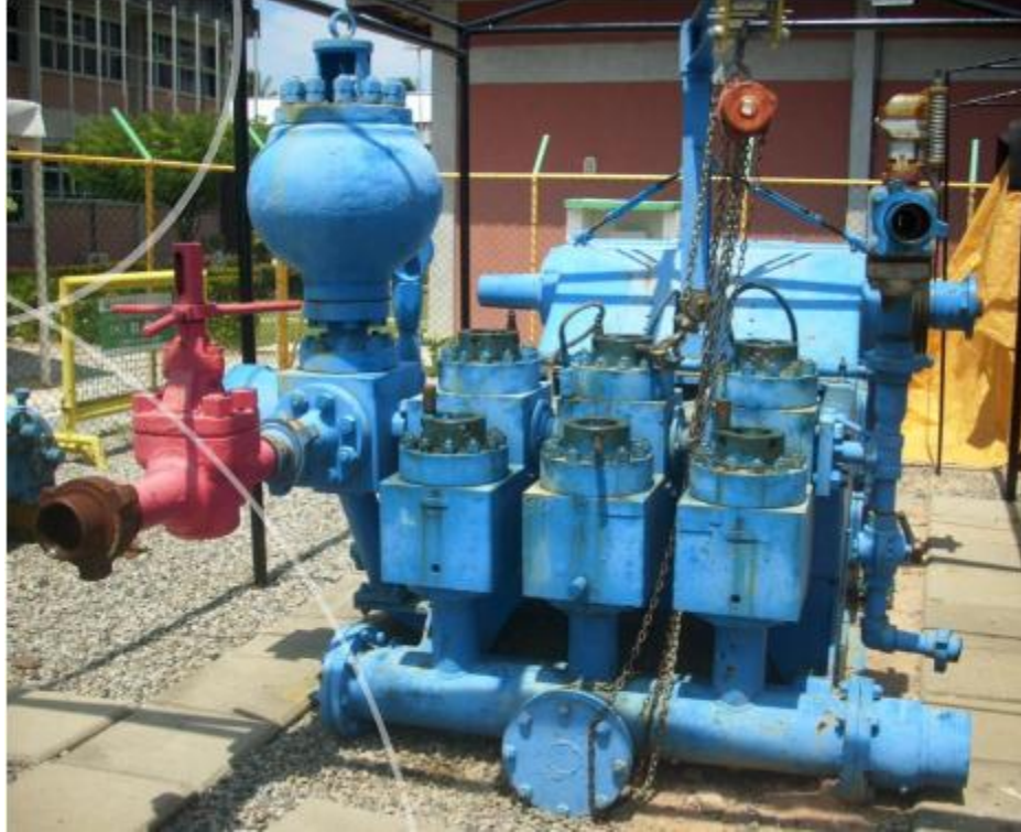
Fig 29: Bomba alternativa triplex
