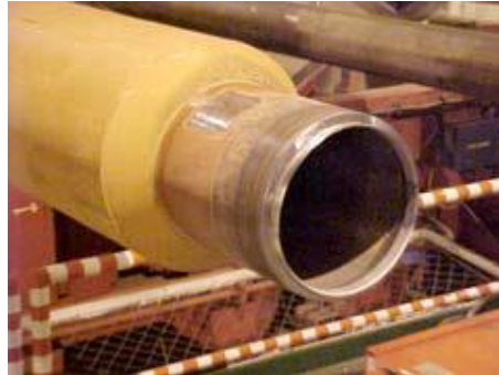
Figura 06: Duto rígido com revestimento
