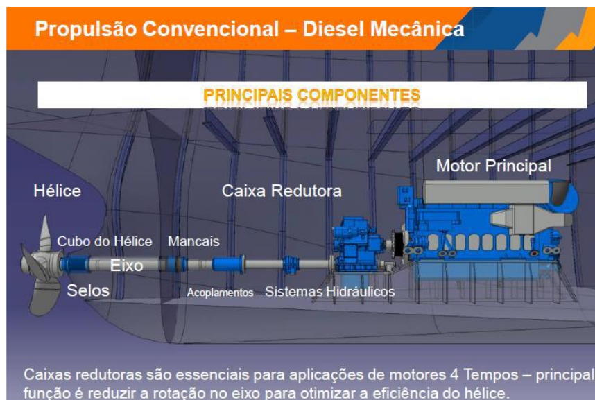
Figura 3: Exemplo de propulsão Diesel-mecânica [13]
