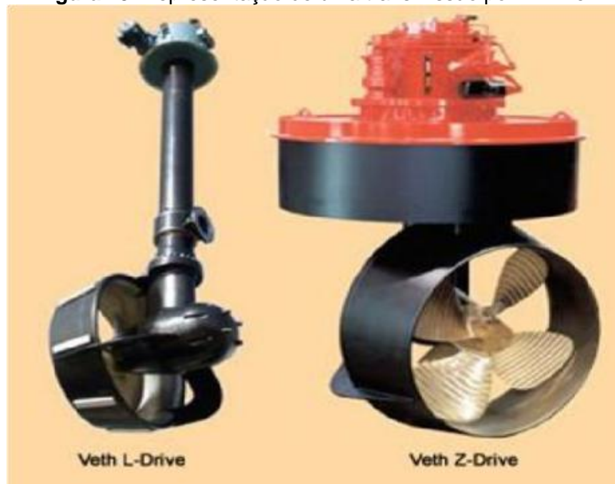
Figura 23: Representação de uma transmissão por L Drive.
