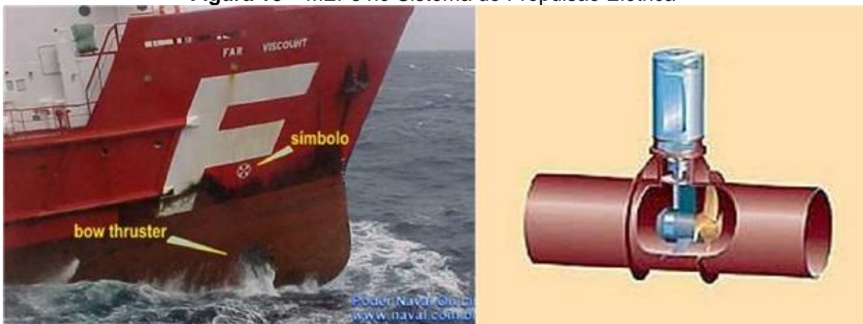
Figura 18 – MEPs no Sistema de Propulsão Elétrica
