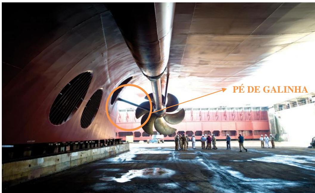
Figura 37: Propulsor sustentado por um “pé de galinha”
