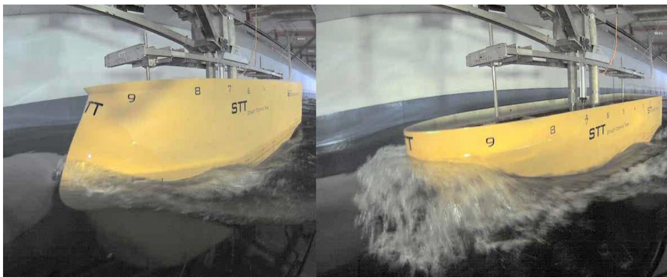
Figura 11: Teste realizado na Holanda para comparar a performance do X-BOW com o bulbo
