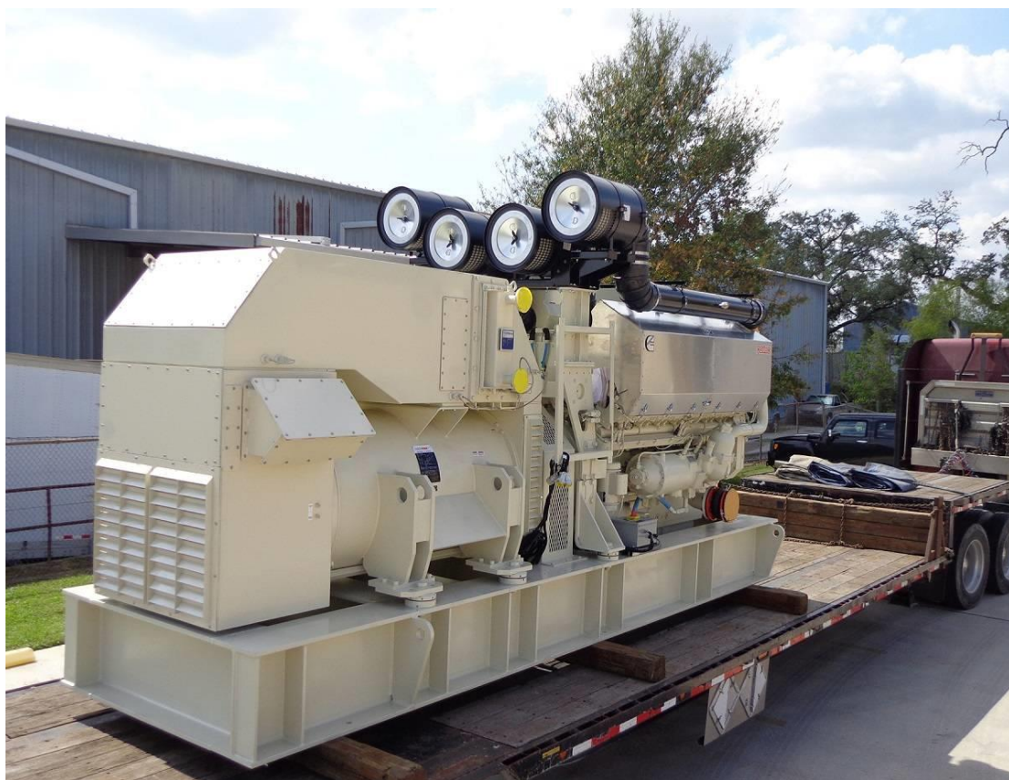
Figura 7 – Gerador Cummins Marine
