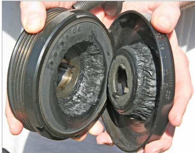
Figura 24: Balanceador com material interno gasto.
