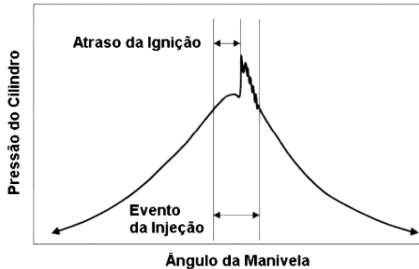
Figura 12: Pressão do Cilindro em função do Movimento do pistão.
