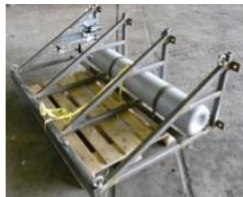
Figura 20 – Unidade geradora de gás
