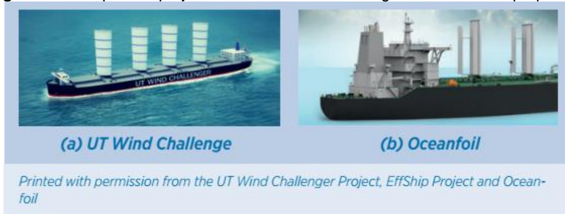
Figura 3: Exemplos de projetos de navios com tecnologia Fixed Sails de propulsão
