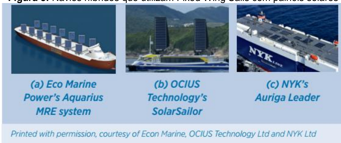
Figura 8: Navios híbridos que utilizam Fixed Wing Sails com painéis solares
