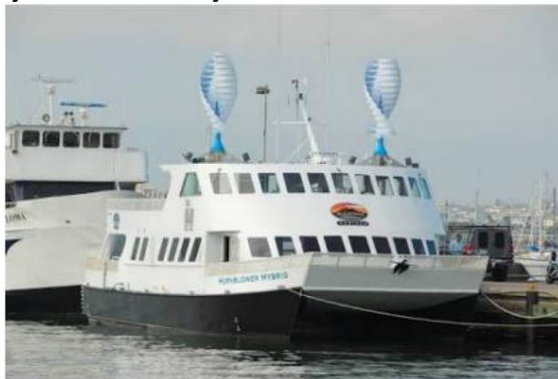
Figura 7: Ferry Hornblower Hybrid com duas turbinas do tipo Savonius
