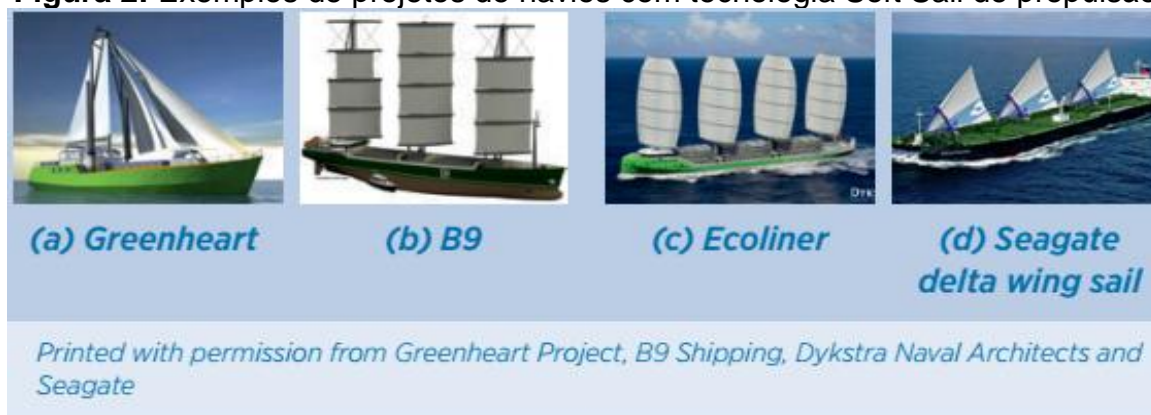
Figura 2: Exemplos de projetos de navios com tecnologia Soft Sail de propulsão
