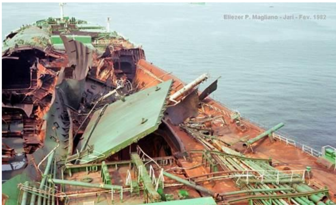
Figura 11: Convés do N/T Jari após explosão
