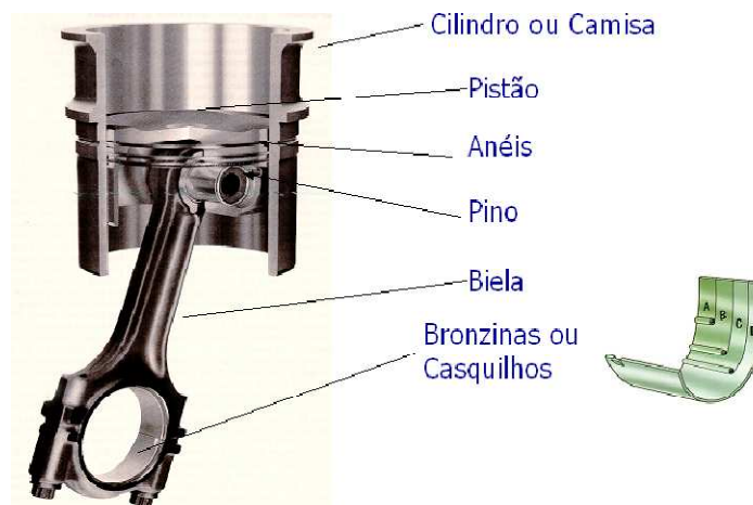
Figura 3: Componentes principais sujeitos a desgaste
