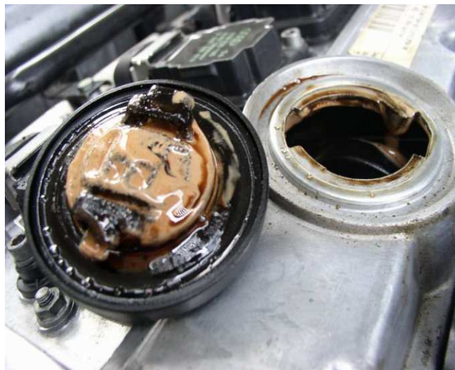
Figura 6: Contaminação do óleo com água
