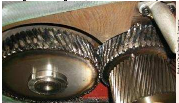
Figura 8: Desgaste por falta de lubrificação
