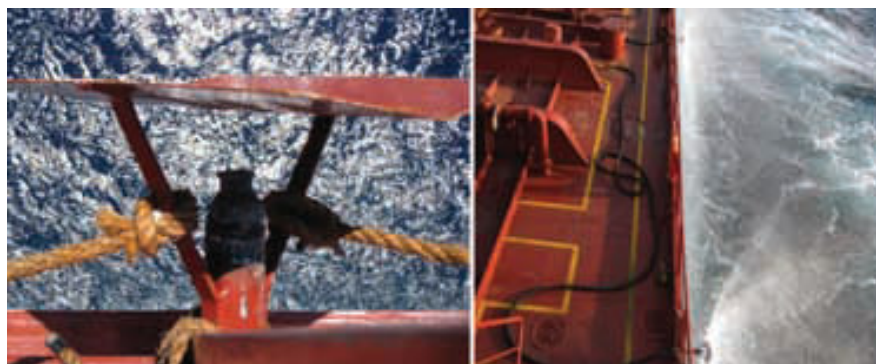
Figura 10 - Chapas metálicas coladas a frente dos esguichos Fonte: OCIMF
