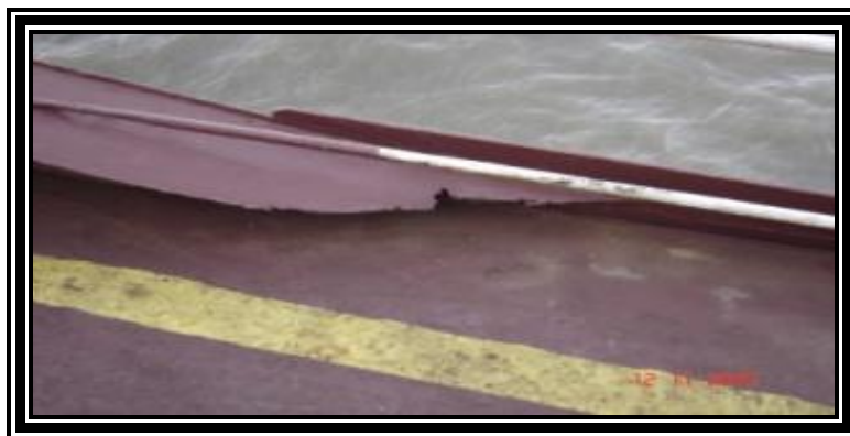
Figura 6 - Confeccionar nova base de reforço do trincaiz próximo a carpintaria
