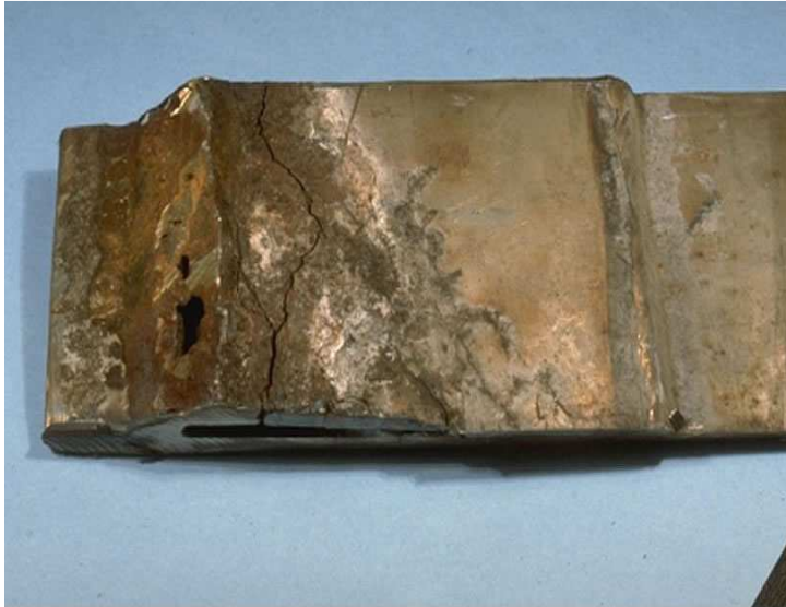
CORROSÃO SOB TENSÃO
