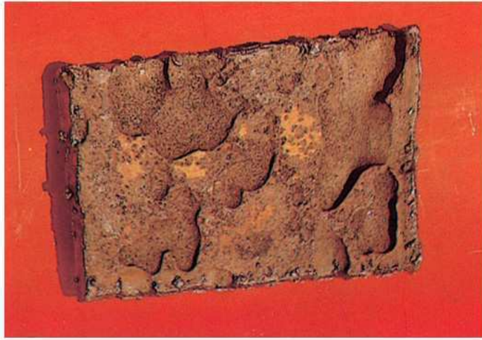
Corrosão em placas.
