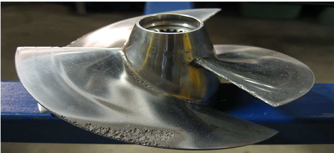
DANOS CAUSADOS POR CAVITAÇÃO
