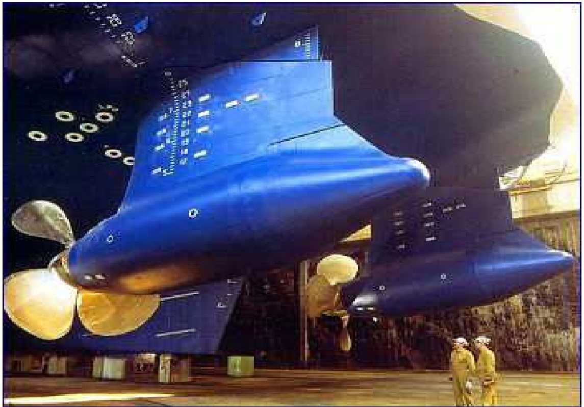
ANODOS DE SACRIFÍCIO UTILIZADOS NA PROTEÇÃO CATÓDICA EM UM NAVIO
