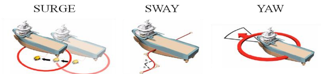
Fig 4 - Movimentos controlados pelo DP
