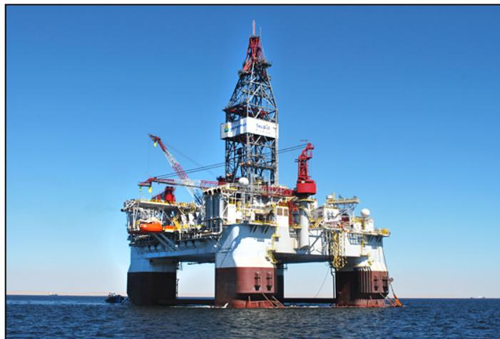
*Plataforma semi-submersível DP West Taurus da Seadrill
