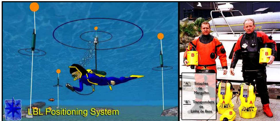
Figura 09: Exemplo de aplicação do sistema LBL por equipes de mergulhadores.
