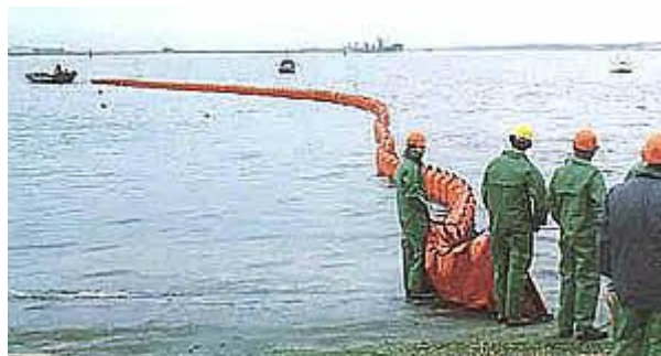
Figura 5.3. Lançamento de barreira de contenção
