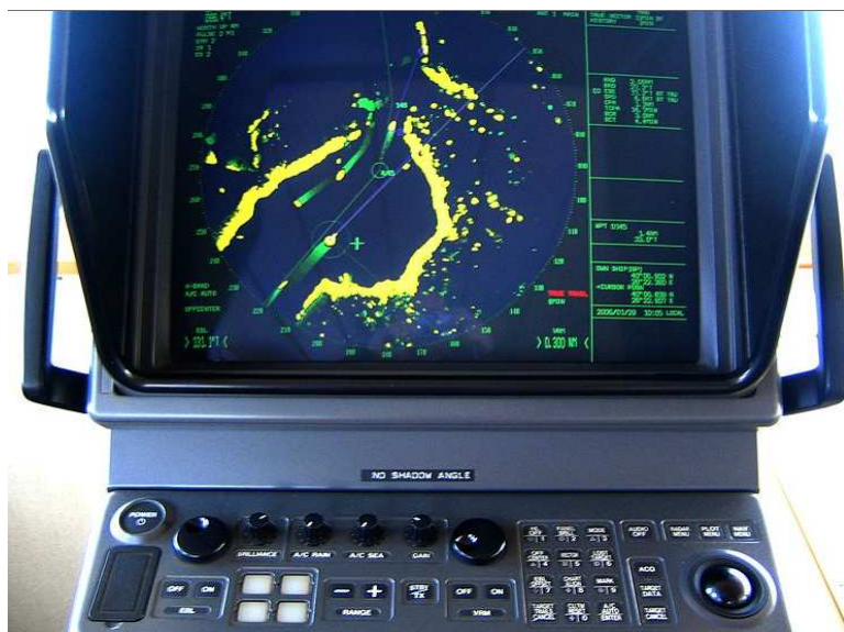
Fig 10 ARPA Na fig 10 imagem de arpa mostrando o navio o movimento dos alvos e a imagem da costa. O arpa é muito importante no sistema ECDIS pois se pode utilizar a sobreposição da imagem no display da carta ENC a fim de comparar com as posições do ECDIS e do radar.
