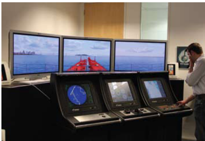
Figura 12 – Painel de simulador total com ECDIS (Imagem cortesia da ECDIS Ltd) Fonte: SS, 2011
