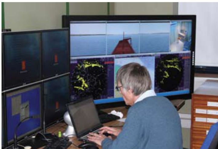
Figura 6 – Os ECDIS modernos usualmente incorporam sistemas navegacionais eletrônicos adicionais (Imagem cortesia da Warsash Maritime Academy) Fonte: SS 2011
