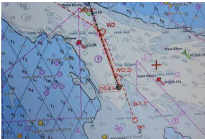
Figura 3 - Electronic Navigational Chart (ENC) (Imagem cortesia da Warsash Maritime Academy) Fonte: SS, 2011.
