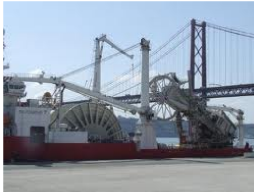
Figura 5 - Navio de lançamento de cabos Fonte: www.portosdeportugal.pt
