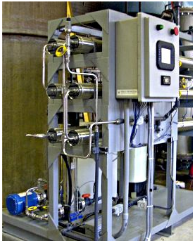
Figura 5 - Outro típico sistema de osmose reversa usado a bordo Fonte: www.desware.net
