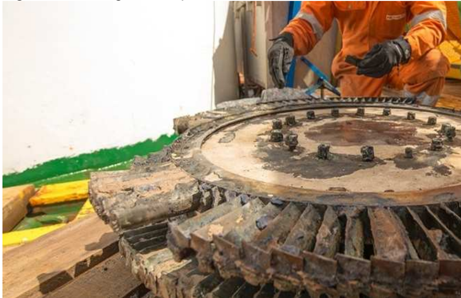
Figura 3 - Erosão por cavitação em turbinas
