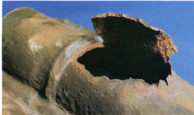
Figura 4: Corrosão ocasionada por ataque de hidrogênio a parede do tubo.
