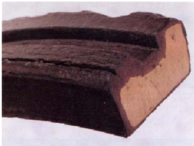
Figura 7: Corrosão por desincificação por camada, em um componente de latão, de uma bomba de água de alimentação de caldeira.
