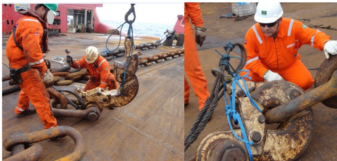
Figura 26: Componentes das linhas de manuseio de âncoras
