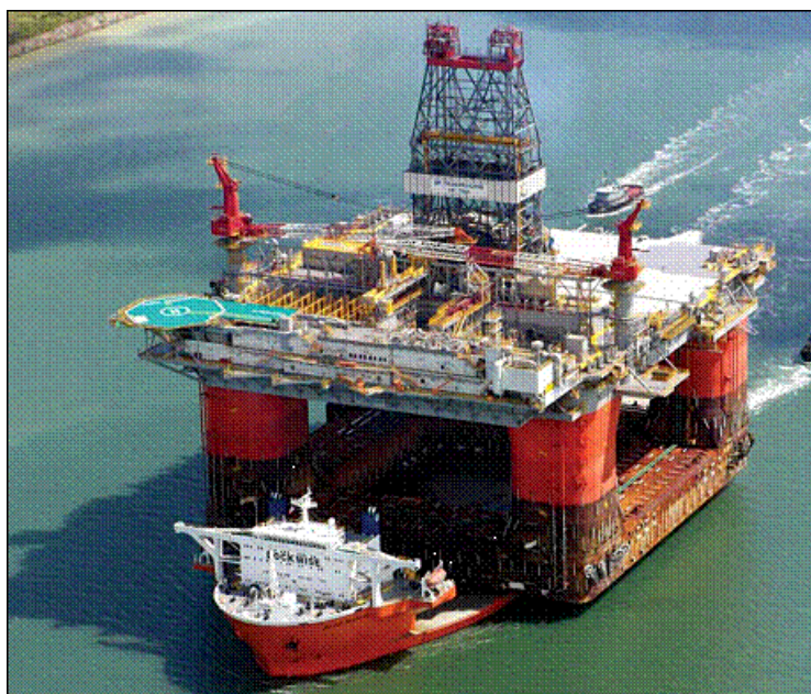
Figura 10: Navio Blue Marlin transportando a plataforma semissubmersível Thunder Horse de 60 mil toneladas
