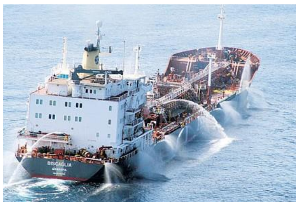
Figura 8 - Navio realizando teste do spray de água
