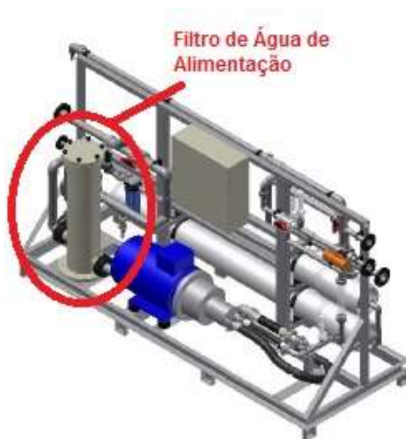
Figura 9 – Detalhe do Filtro de Água de Alimentação
