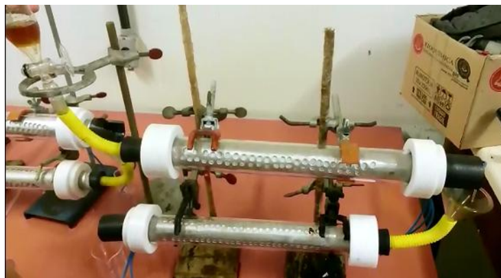
Figura 12: imagem do tubo revestido do filtro e suas janelas.
