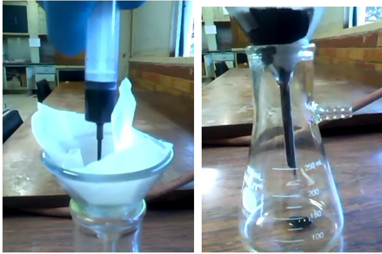
Figuras 7 e 8: Fase2: desenvolvimento do filtro. O óleo consegue passar pelo filtro.
