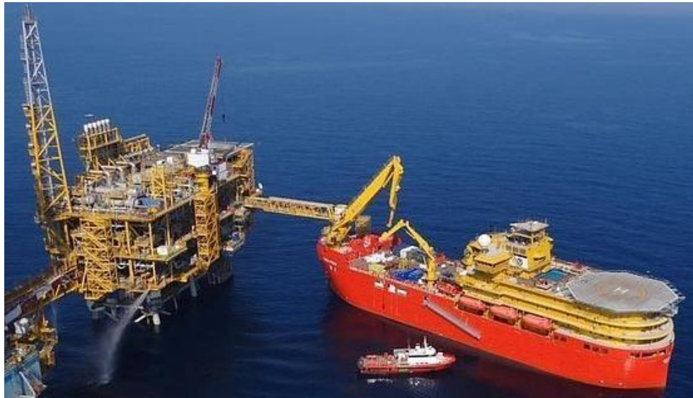
Figura 30: Flotel conectado a plataforma através da gangway .
