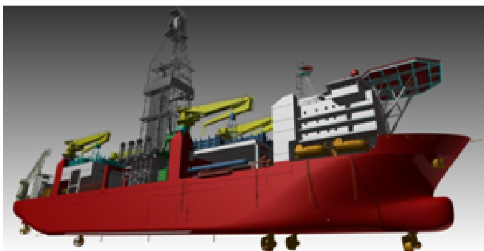
Figura 20: Drill Ship Dotado de um Sistema DP
