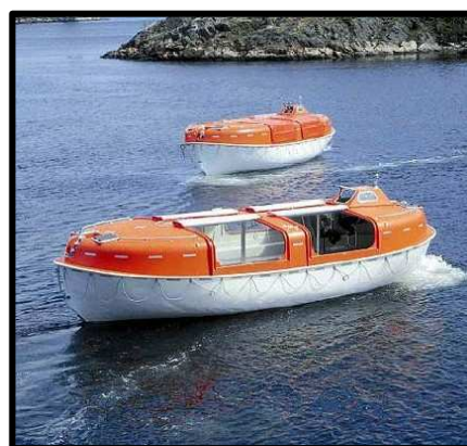
Figura 3. Baleeira parcialmente Fechada
