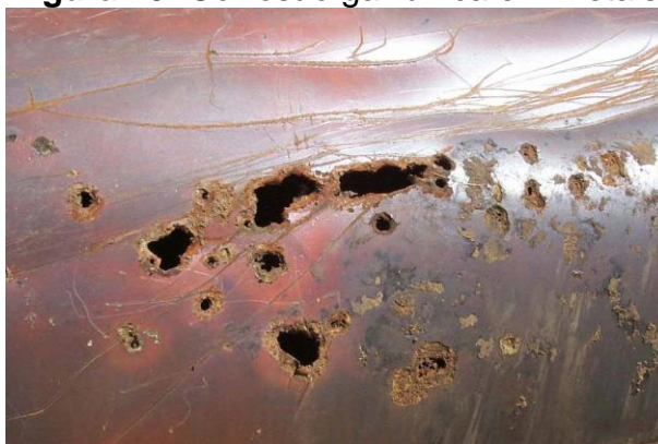
Figura 10: Corrosão galvânica em metais
