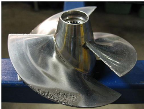
Figura 8: Corrosão por fadiga por cavitação
