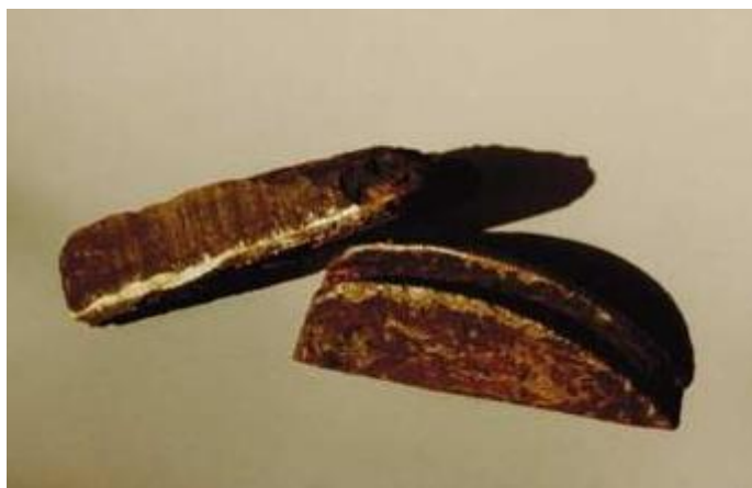
Figura 12: Corrosão gráfítica em componente de bomba centrífuga de ferro fundido
