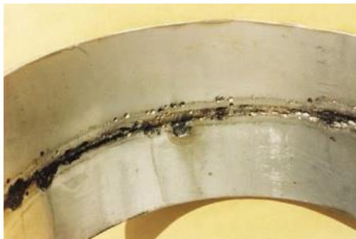
Figura 14: Corrosão em aço inoxidável em torno de corrosão de solda
