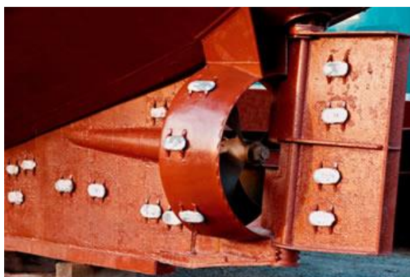
Figura 23: Placas de zinco colocadas diretamente em contato com o casco
