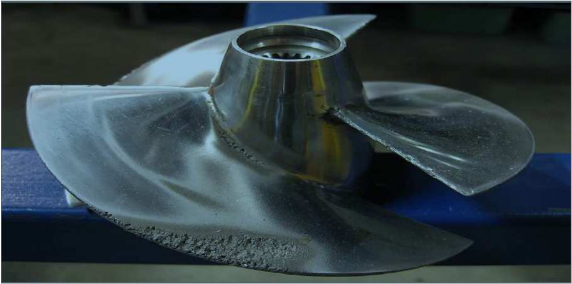
Figura 13: Exemplo de corrosão por cavitação em propulsor
