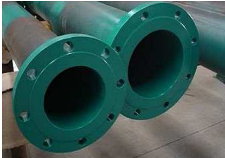
Figura 17: Tubulações de água salgada sendo pintadas
