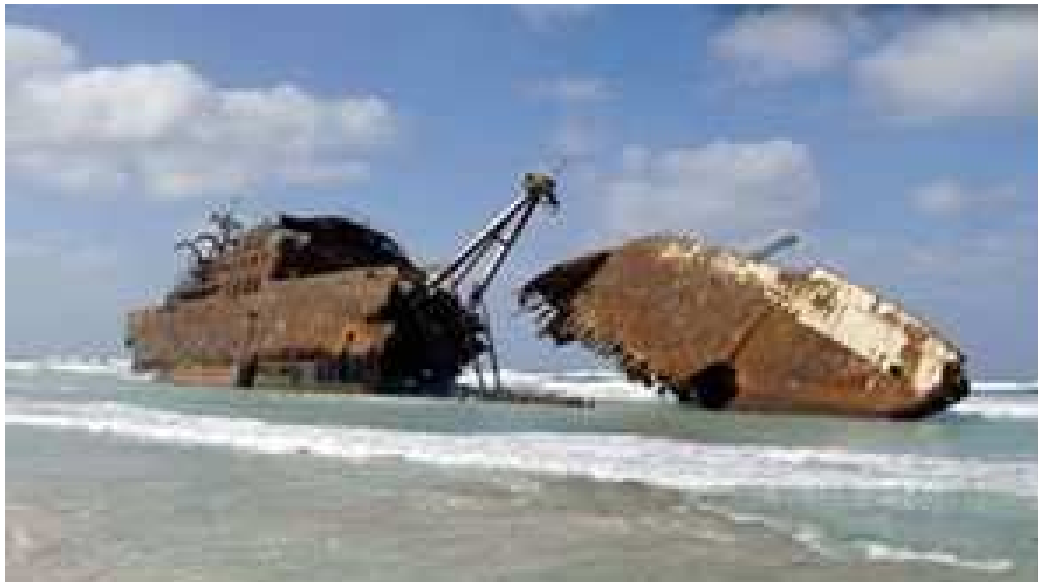
Figura 1: Embarcação que sofreu corrosão fraturante sob tensão
