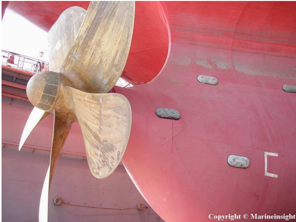
Figura 15: Anodos de sacrifício no casco de uma embarcação
