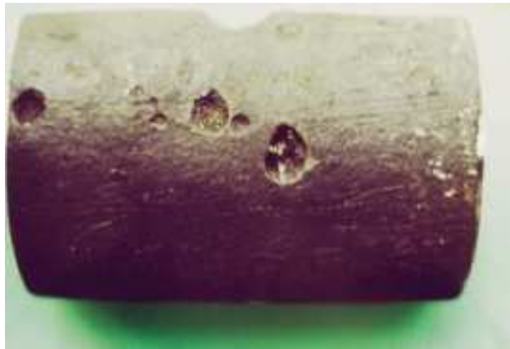
Figura 4: Peça metálica com corrosão alveolar
