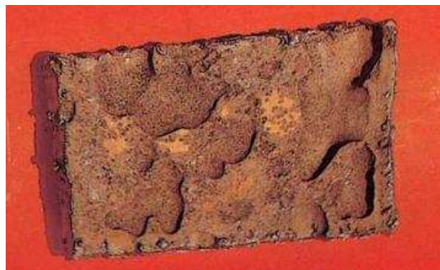
Figura 3: Chapa metálica que sofreu corrosão em placas
