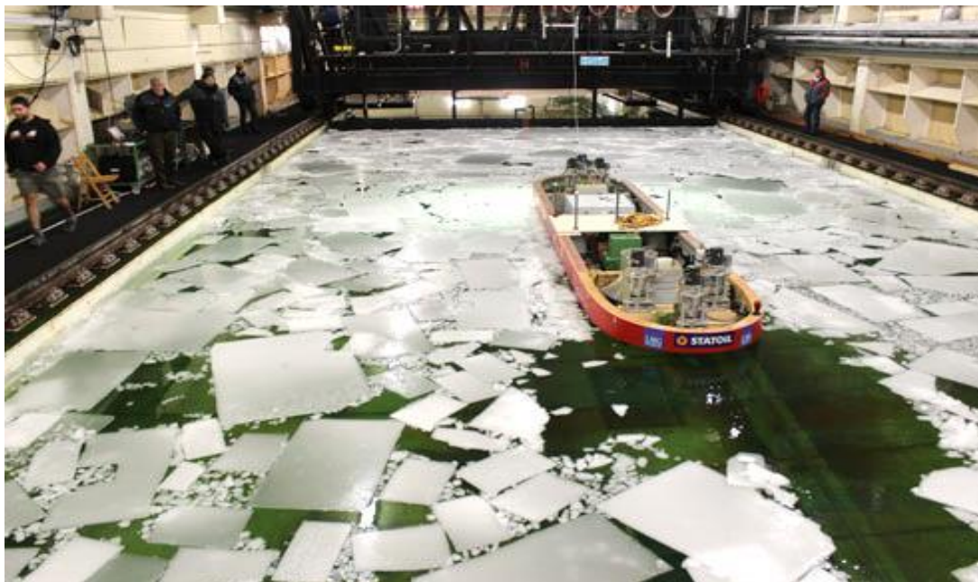
Figura 6 – Tanque de provas para ensaios em superfícies com gelo
