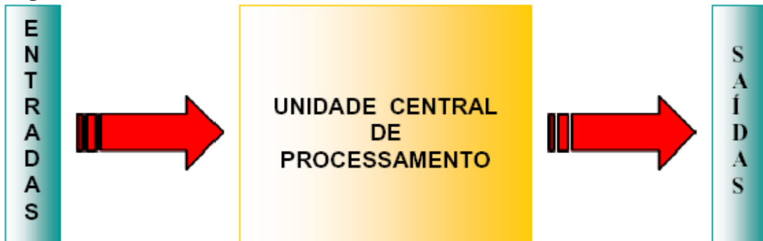
Figura 8: Estrutura básica de um CLP
