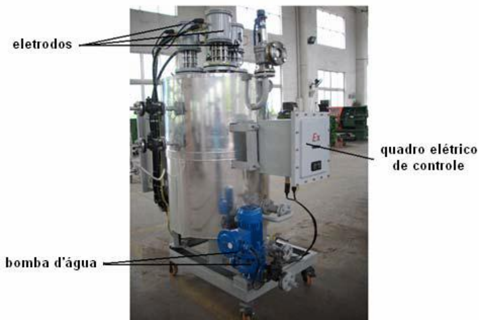
Figura 7 - Caldeira elétrica do tipo eletrodo
