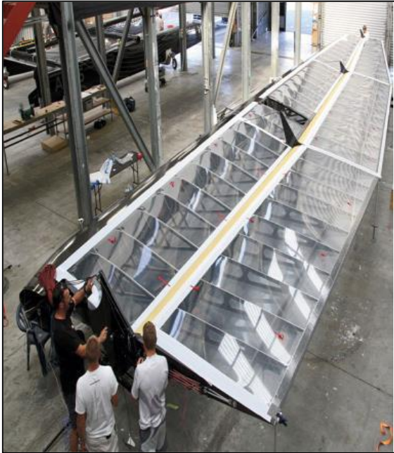
Figura 17: Wing sail de materiais compósitos usada na America's Cup
