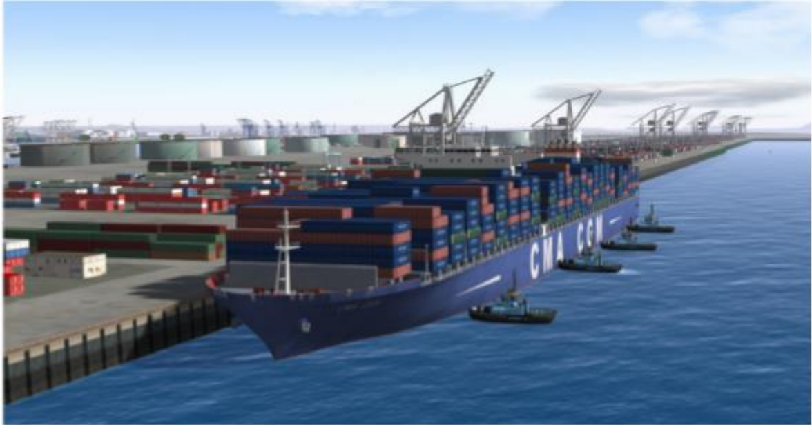
Figura 22 - Manutenção do PC atracado por rebocadores empurrando e sob ação de forte vento soprando de terra
