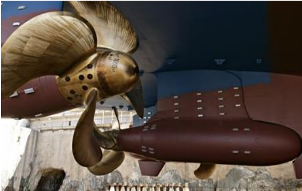
Figura 20 – Propulsor azimuthal Azipod patentado pela ABB Motors
