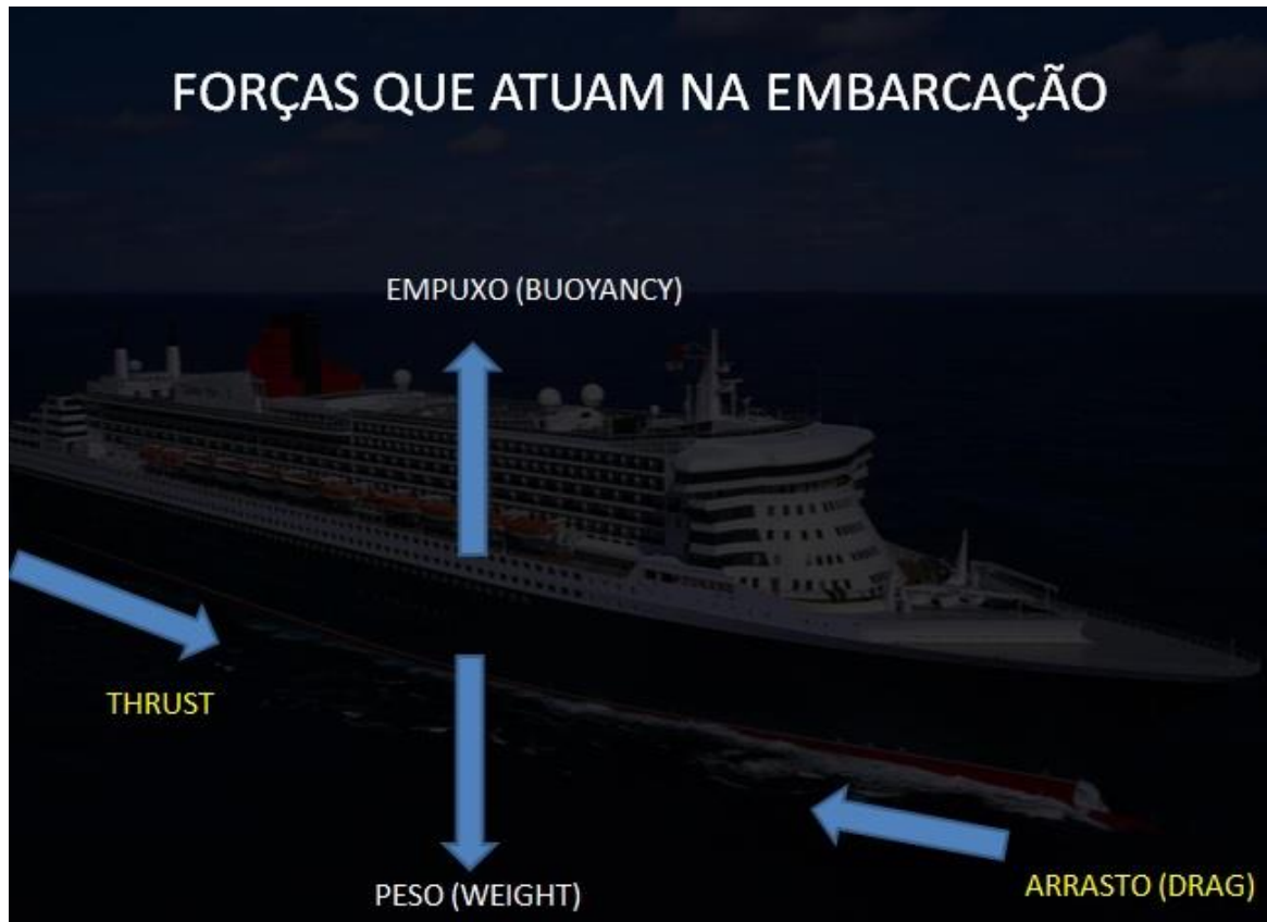
Figura 1 – Forças que atuam em uma embarcação
