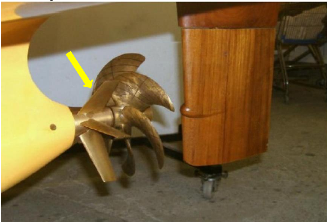
Figura 9 - Pre-swirl stator do estaleiro sul-coreano Daewoo
