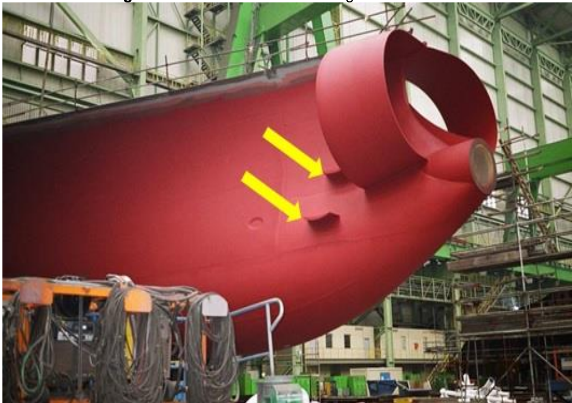
Figura 12 - Duto Schneekluth integrado com aletas
