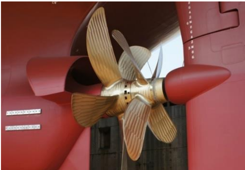
Figura 22 - Sistema de hélices contra rotativas
