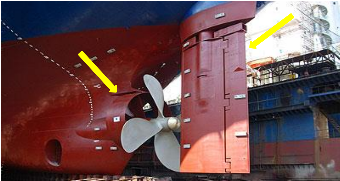
Figura 10 - Duto Becker Mewis integrado com leme Becker
