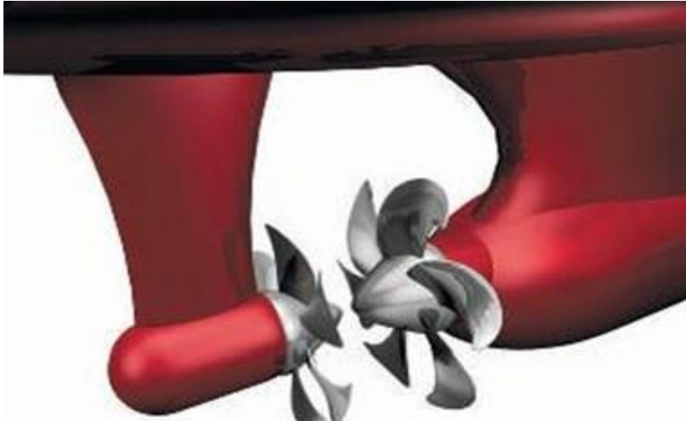
Figura 23 – Sistema de hélices contra rotativas com eixos independentes
