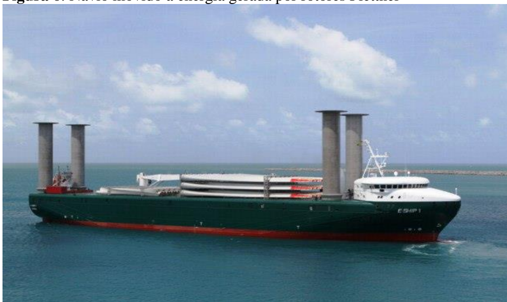
Figura 6: Navio movido a energia gerada por rotores Flettner
