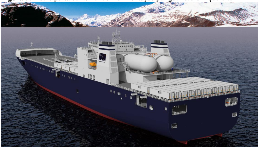
Figura 5: Navio porta contêiner com alimentação por gás natural liquefeito
