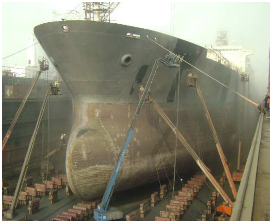
Figura 11 – Tratamento e pintura do casco 2
