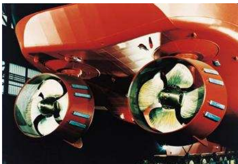
Figura 8 - Rebocador Azimutal Trator reverso
