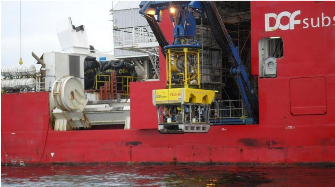
**Figura 19 – ROV acoplado na TMS**
