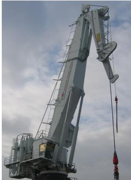
Figura 28 – Guindaste de 140 toneladas com compensador de *heave*.
