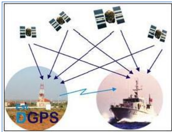
Figura 13 - Esquema de funcionamento do DGPS
