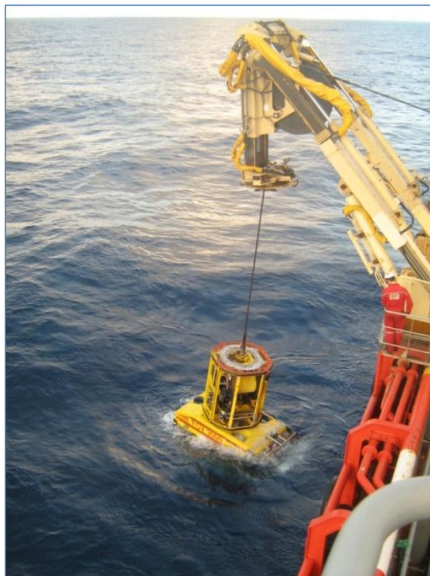
Figura 25 – Lançamento do ROV – Mergulhando o ROV (CBO RIO)
