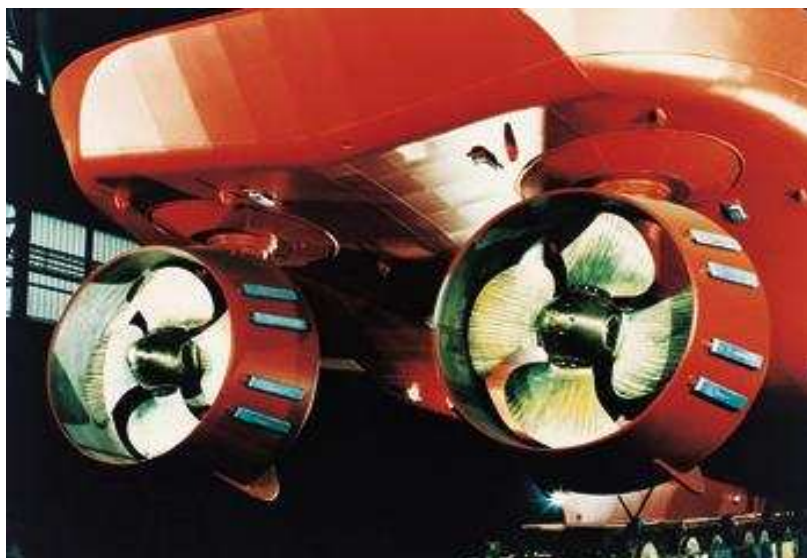
Figura 3-Rebocador Trator reverso com propulsão Azimutal.
