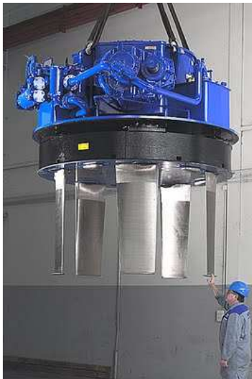
Figura 5 – Sistema Voith- Schneider
