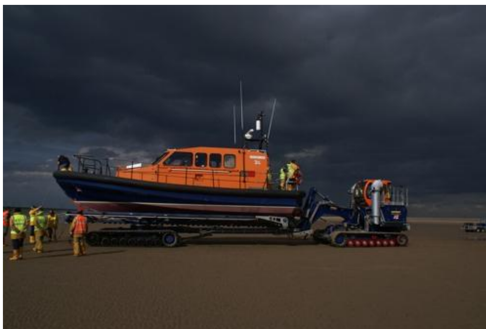
Figura 16 – Protótipo do FCB2 do RNLI no Supacat em Hoylake, Nr Liverpool. Fonte: RNLI/Backwell, 2011
