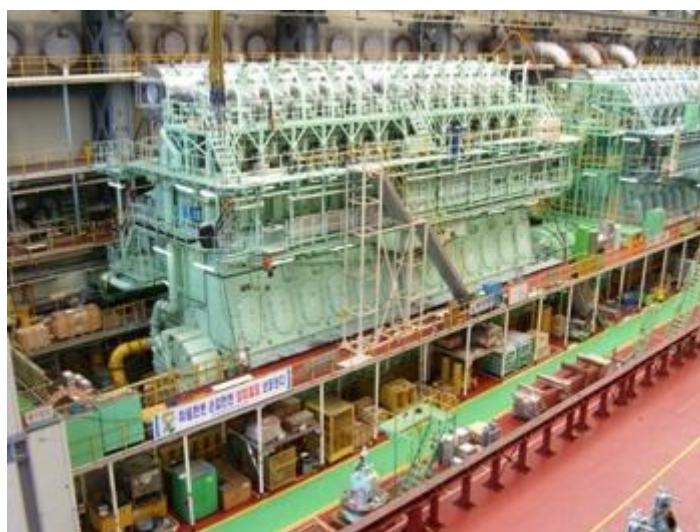
Figura 5: Motor marítimo a diesel MAN S90ME-C9.2. Fonte: Foto da Man Diesel & Turbo / Backwell, 2012a
