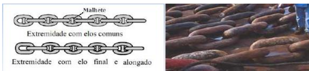
Figura 7 Exemplo de elos com e sem malhete.
