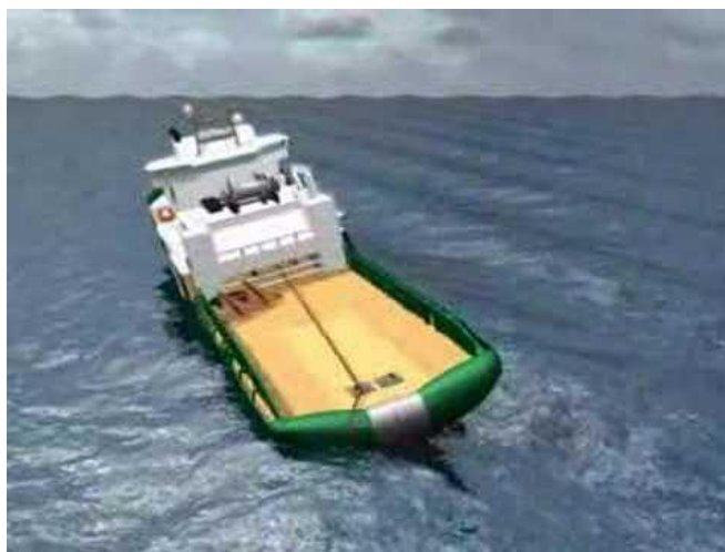
Figura 20 Simulação do adernamento para bombordo após o pino interno de boreste ter sido abaixado.
