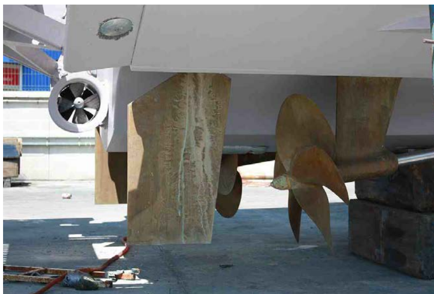
Figura 15 – Sistema de dois hélices e dois lemes
